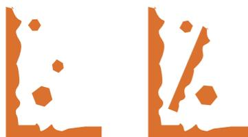
**DESLIZAMIENTO** Es un movimiento de una masa de suelo o roca que ocurre a lo largo de una superficie de falla con una gran deformación cortante.
