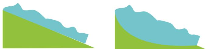
**A)** Deslizamiento traslacional.- Es un tipo de deslizamiento en el cual la masa se mueve a lo largo de una superficie de falla plana u ondulada, estos movimientos suelen ser más superficiales que rotacionales y el desplazamiento ocurre con frecuencia a lo largo de discontinuidades como fallas, diaclasas, planos de estratificación o planos de contacto entre la roca y el suelo residual o transportado que yace sobre ella.
